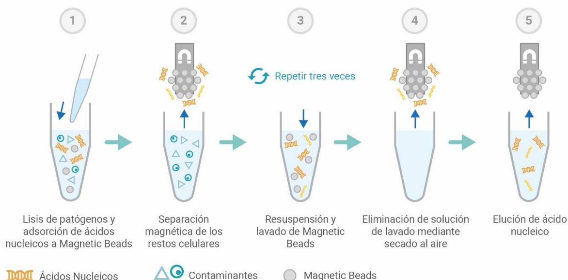
Figura 1. Principio básico de extracción basado en partículas magnéticas para un instrumento automático de transferencia de partículas magnéticas.
